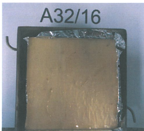
Fot. 1. Próbka sklejk o gr. 30 mm przed badaniem
