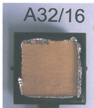
Fot. 1. Próbkę sklejkę o gr. 25 mm przed badaniem
