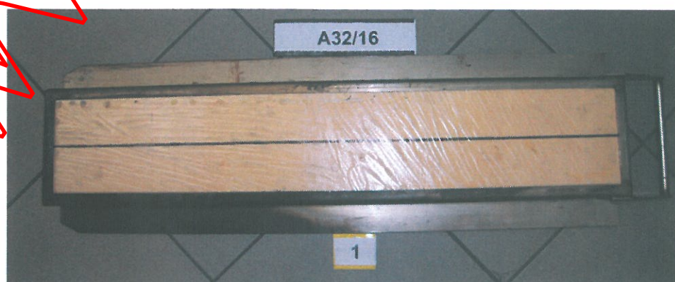
Fot. 1. Próbkę sklejkę o gr. 30 mm przed badaniem
